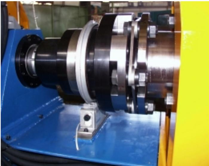
Particolare del montaggio torsionmetro
